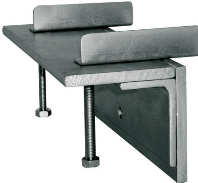
Ausführung als Verbindung zwischen einer **neuen Bodenplatte im Anschluss an eine bestehende Bodenplatte** in hochbeanspruchten Betonnutzflächen. Als Kantenschutz und zur Lastübertragung auf voller Profillänge. Konstruktion mit Stahlkantenschutz und Einbauhilfe. Befahrbar mit Flurförderfahrzeugen, PKW und LKW.
