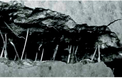
Durch Endhaken «vernageln» die Stahldrahtfasern den Riss
