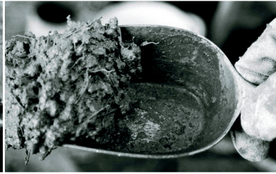
Homogene und dreidimensionale Verteilung der Stahldrahtfasern
