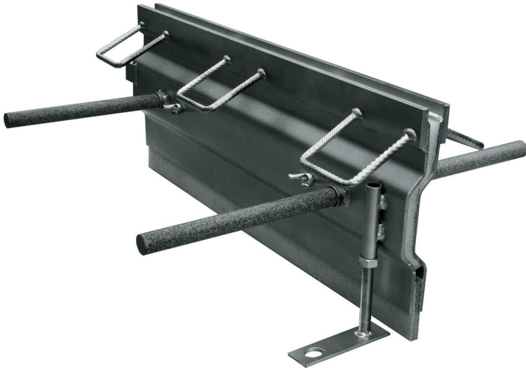
Ausführung als verlorene Schalung an **Bewegungsfugen** (Dilatationsfugen), welche temperaturbedingten Längenänderungen unterliegen (z.B. in Freiflächen). Als Fugenkantenschutz und zur Querkraftübertragung durch Runddübel. Konstruktion mit **scharfkantigem Stahlkantenschutz**, stufenloser Höhenjustierung, Fließbarriere, U-Betonanker und Runddübelhülsen. Befahrbar mit Flurförderfahrzeugen, PKW und LKW.
